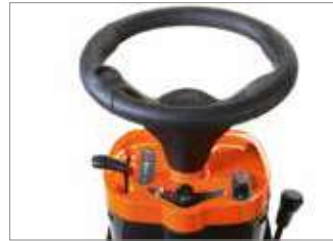
El acoplamiento del embrague electromagnético se realiza de modo rápido y silencioso mediante un cómodo botón situado en el tablero de mandos.
