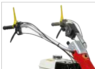
Embragues de dirección independientes en las ruedas motrices, con bloqueo de las ruedas para facilitar las maniobras.
