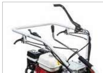
Dirección con desbloques y frenos independientes.
