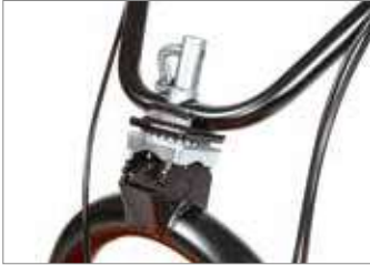
Manillar dotado de palanca para la regulación vertical y horizontal.
