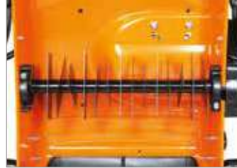
Rotor compuesto por 15 cuchillas fijas.
