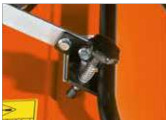
Mando de regulación de la profundidad de trabajo. Garantiza el mantenimiento constante de la posición preestablecida.
