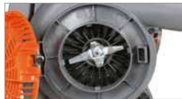
Cuchilla trituradora con cuatro hojas de acero, suministrada de serie, que reduce al mínimo el volumen de la hierba dentro del saco (hasta 1/12 del original) y, por lo tanto, permite trabajar más tiempo sin detenerse a vaciarlo.
