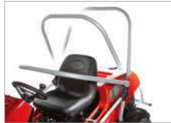
Equipados de serie con arco, parachoques delantero y trasero, protecciones laterales y cinturones de seguridad para minimizar los riesgos incluso en situaciones difíciles.
