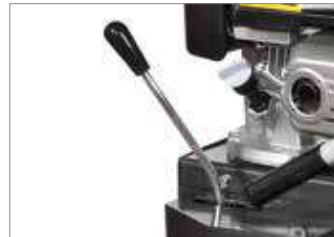
Selector de velocidades con palanca.
