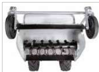
Rotor con cuchillas en 'Y', potentes y resistentes, para triturar césped y sarmientos con la máxima eficiencia y sin temor a golpes o heridas.
