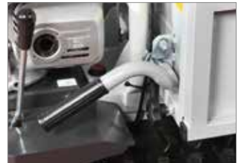
Basculamiento manual con sistema de bloqueo automático.
