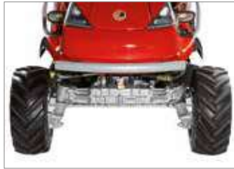
Las bandas de rodadura anchas y el centro de gravedad bajo aseguran la máxima estabilidad en terrenos accidentados o en proximidad de orillas y cunetas.
