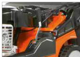
Regulación centralizada de la altura de corte mediante una cómoda palanca con posiciones predefinidas.
