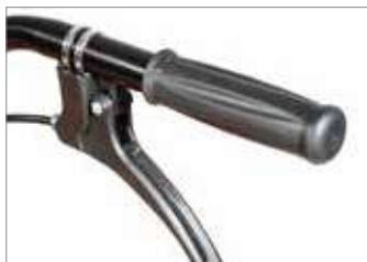
Regulación rápida y cómoda de la altura de corte en 4 posiciones.
