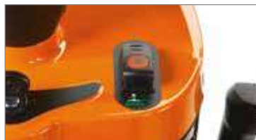
El acoplamiento del embrague electromagnético se realiza de modo rápido y silencioso mediante un cómodo botón situado en el tablero de mandos.
