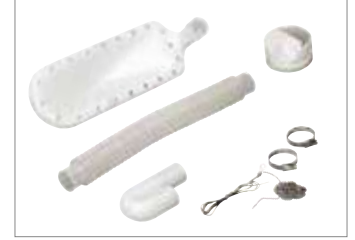
Kit de conversión MB 163 para tratamientos con polvos químicos o gránulos finos. Los polvos o gránulos no entran en contacto con el ventilador, sino que se envían directamente al tubo de salida.
